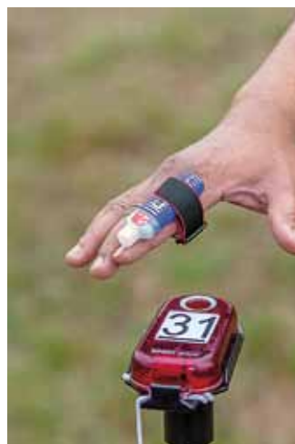
Kontaktlose Zeitnehmung mit der SIAC, der SPORTident ActiveCard.
